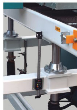
锯轮的升降通过精密的滚珠丝杆传动,并通过数字精密显示仪将升降量以1/100mm的精确度对锯轮进行显示
