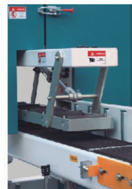
采用整体送料压架能对多排木料同时进行锯切
